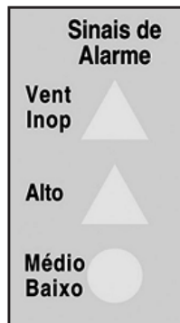
Fig. 4-7 Aparência da área Sinais de Alarme onde encontram-se os indicadores luminosos.
