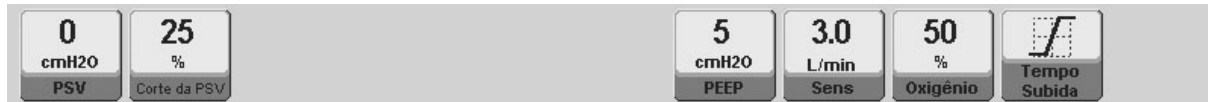
Fig. 9-9 Imagem de controles dos modos PSV/CPAP configurados para realizar respirações com características CPAP. Com exceção do PSV, os outros parâmetros usam os valores predefinidos do modo PSV/CPAP.
