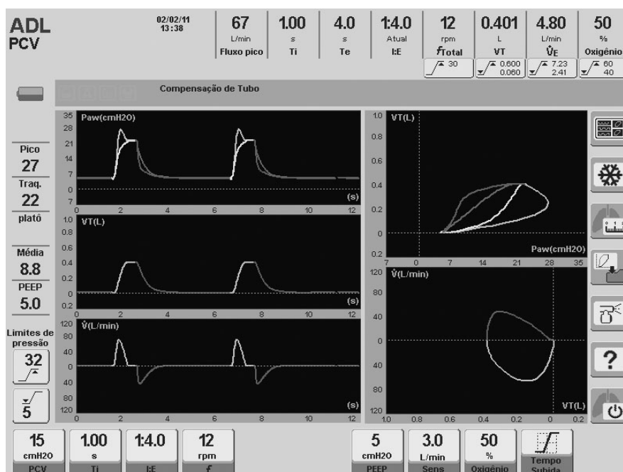
Fig. 7-7 Tela capturada durante ventilação em modo PCV. A imagem mostra os gráficos de P_{traqueal} e P_{aw} . A P_{traqueal} monitorada está embaixo do valor Pico .
