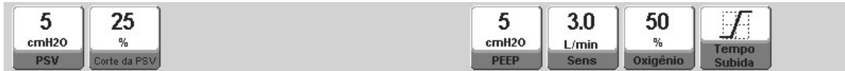
Fig. 9-8 Imagem dos controles habilitados na PSV, categorias ADL e PED. Mostrados com os valores predefinidos de cada um deles.
