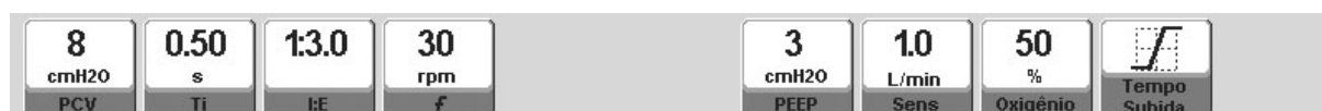
Fig. 10-4 Imagem dos controles PCV habilitados, categoria NEO. Exibidos com os valores predefinidos para cada um.
