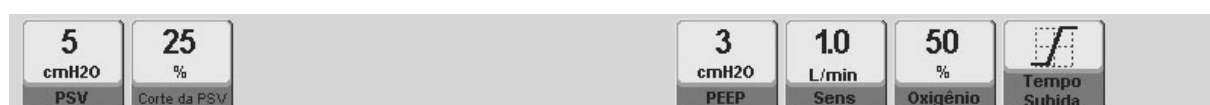
Fig. 10-6 Imagem dos controles PSV/CPAP habilitados, categoria NEO. Exibidos com os valores predefinidos para cada um.
