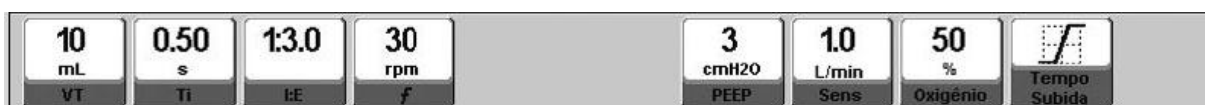
Fig. 10-20 Controles habilitados do PRVC. Exibidos com os valores predefinidos para cada um.
